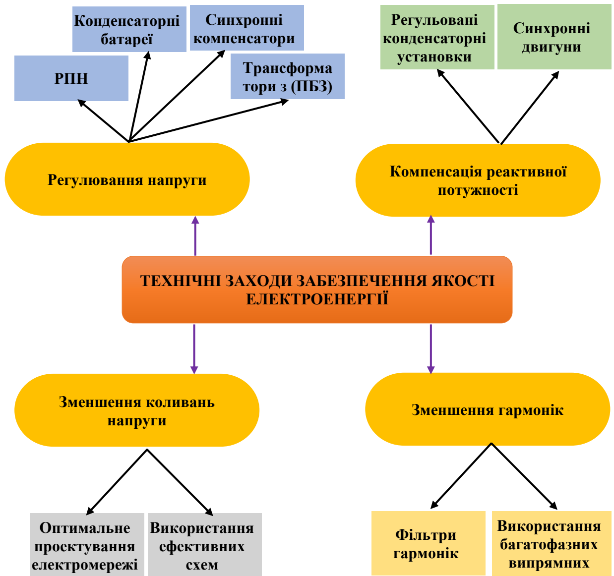
Рисунок 7.2 - Спрощена структурна схема впровадження технічних заходів для забезпечення якості електроенергії на підприємстві.
