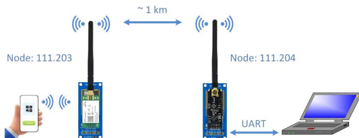
Рисунок 33 - Підключення вузлів мережі для тестування
