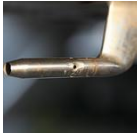
Рисунок 4.5 – Принцип роботи трубки Піто для вимірювання швидкісного напору.
