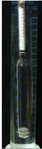
Рисунок 1.3 - Вимірювання густини рідини ареометром.
