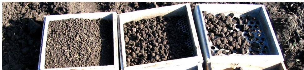
Рис. 3.2. Ситовий аналіз агрегатного складу обробленого ґрунту
