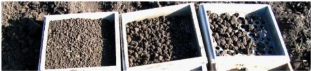
Використання сит для розділення ґрунту на фракції
