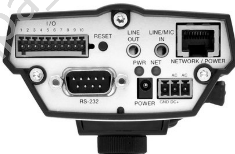
Рисунок 3.2 – Задня стінка відеокамери з доступними інтерфейсами взаємодії застосовувана при реалізації дипломного проекту
