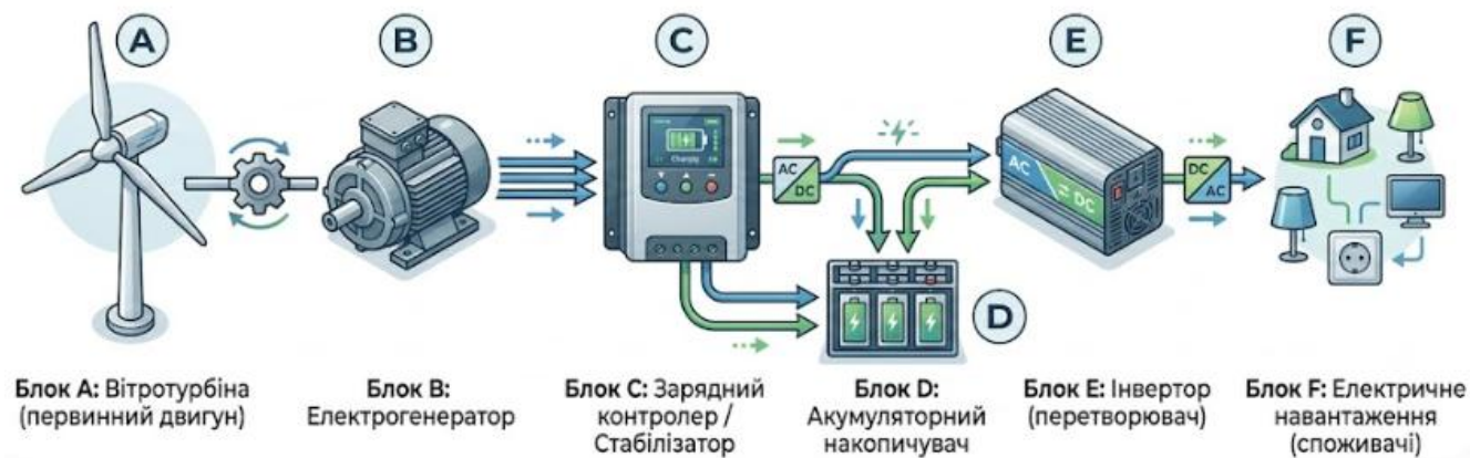
Рис. 7.1. Блок-схема компонування автономного вітрогенераційного комплексу з акумуляторним резервуванням
