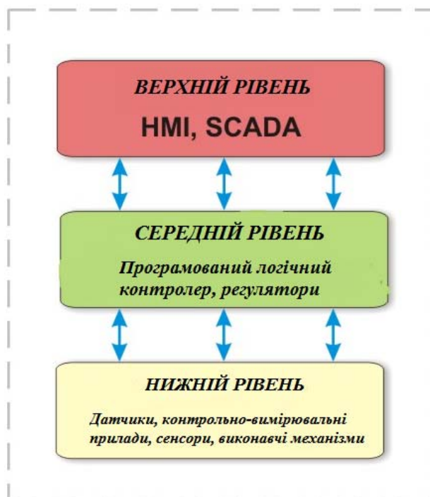
Рисунок 2.3 – Функціональна схема рівнів системи керування стабілізації тиску в магістралі
