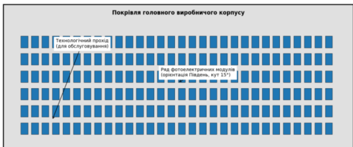
Рисунок 9.5. Схема просторового розміщення масиву фотоелектричних модулів на покрівлі головного корпусу
