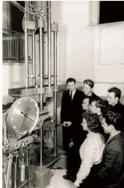
Кафедра обробки металів тиском. Установка для випробування зразків на розтяжку
