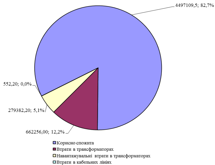
Рис. 7.5. Графічна модель розподілу та генерування реактивної складової енергоносія в межах підприємства
