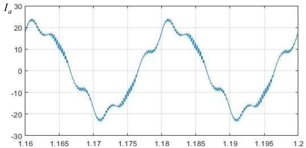
Рис. 3.3.8. Графік зміни струму фази асинхронного двигуна приводу вентилятора (2 дослід)
