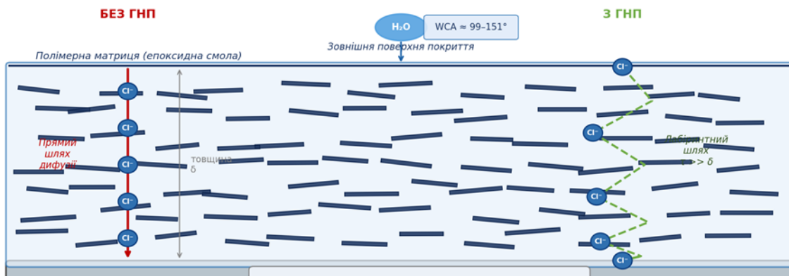
Рисунок 2.1 – Бар’єрний механізм антикорозійного захисту: «ефект лабіринту» у полімерному покритті з ГНП
