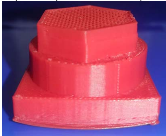
Рисунок 10 – Явище деформації прямокутної основи надрукованого зразка з ABS пластика Джерело: розроблено авторами
