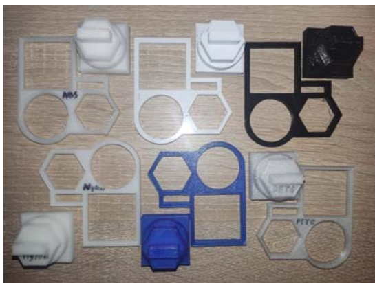
Рисунок 7 – Надруковані дослідні зразки з пластиків PLA, ABS, PET-G, PETG та CoPET
