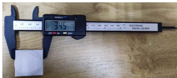
Рисунок 8 – Вимірювання розмірів характерних поверхонь дослідних зразків
