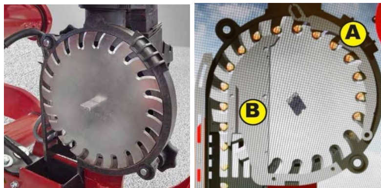
Рис. 2.13 – Загальний вигляд дозуючого диска з радіальними пазами
