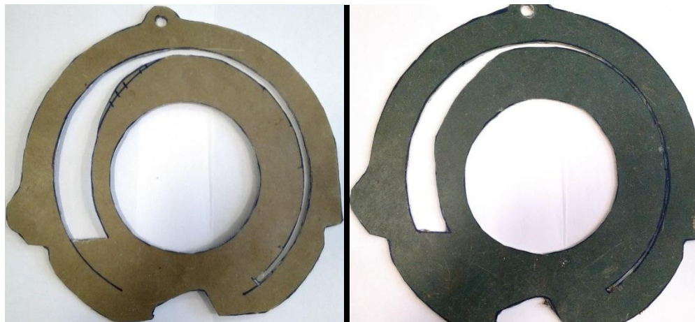
Рис. 2.18 – Оригінальна прокладка вакуумкамери
