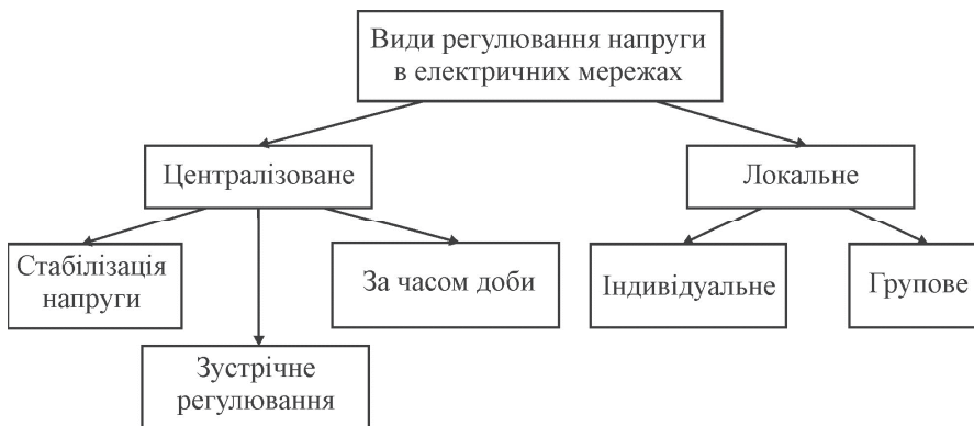
Рис. 2.1. Підходи до регулювання напруги в РЕМ
