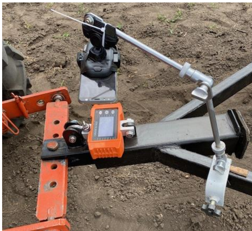
Рис.3.2. Використання електронного тягоміра для фіксування тягового опору робочих органів
