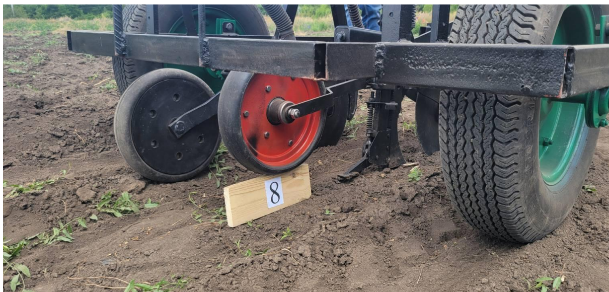
Рис.3.3. Встановлення глибини ходу долотовидного сошника
