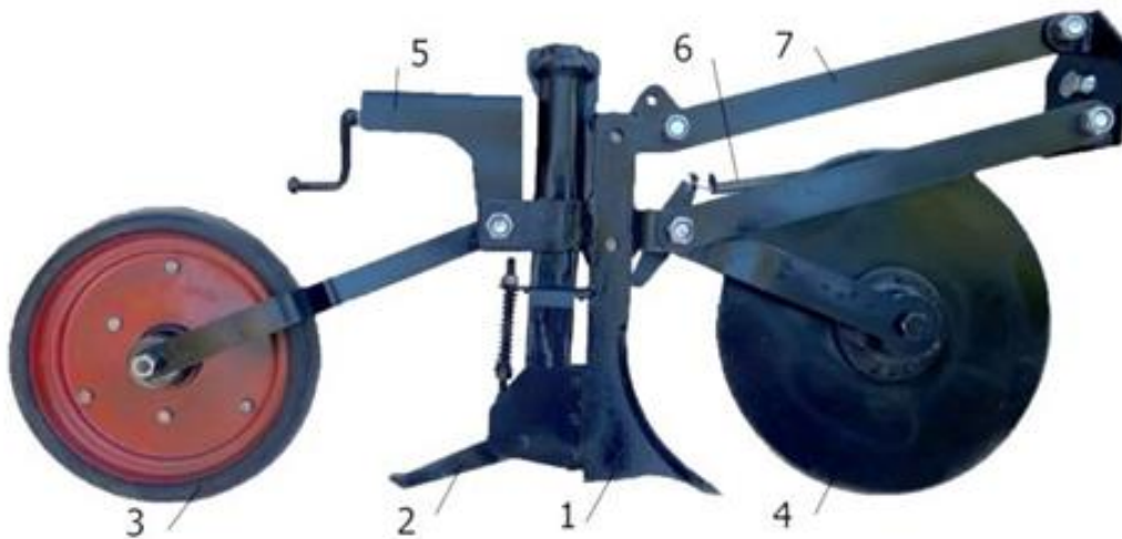
Рис.3.1. Загальний вигляд експериментальної посівної секції: 1 – сошник долотовидний; 2 – утримуюча п’ятка; 3 – прикочуючий коток; 4 – диск; 5 – механізм регулювання глибини ходу; 6 – притискна пружина; 7 – паралелограмний механізм навіски.
