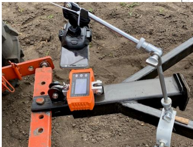
Використання електронного тягоміра для фіксування тягового опору робочих органів
