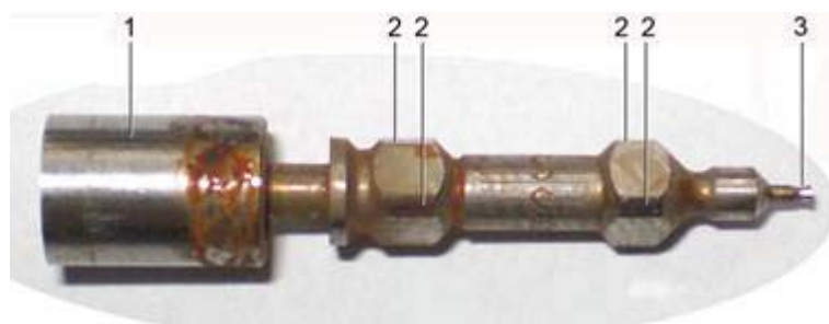
1 – сердечник; 2 – направляющие грани; 3 – запорный элемент штока
