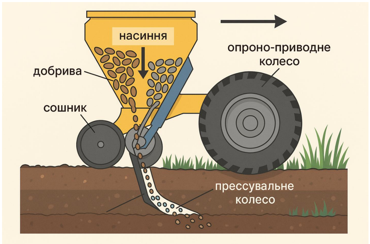
Рисунок 1.5 - Принцип роботи зернотукової сівалки
