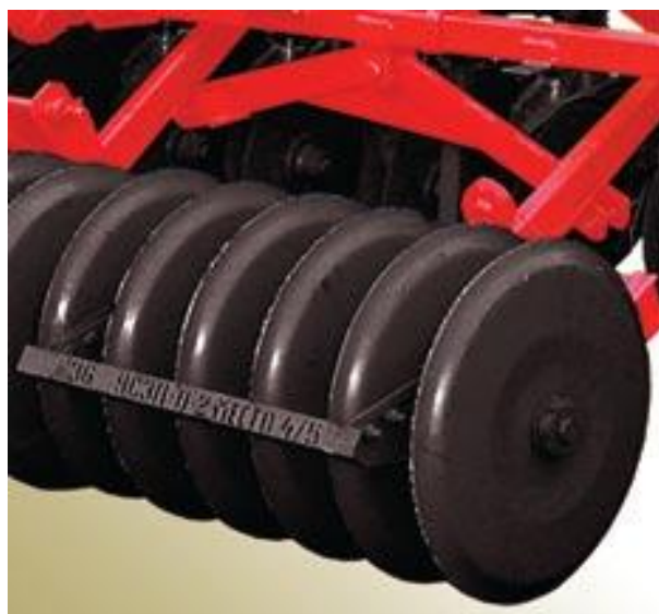
Рисунок 1.3 - Фрагмент сошників сівалки
