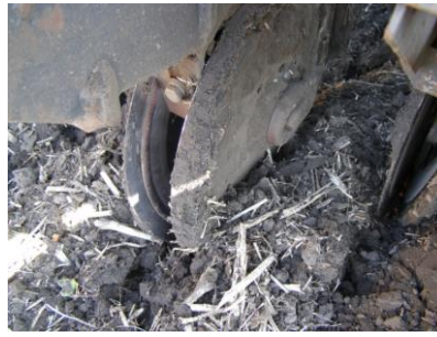
Рис. 4 – Дводисковий сошник сівалки GREAT PLAINS 4
