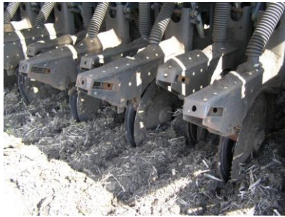
Рис. 4 – Дводисковий сошник сівалки GREAT PLAINS 4
