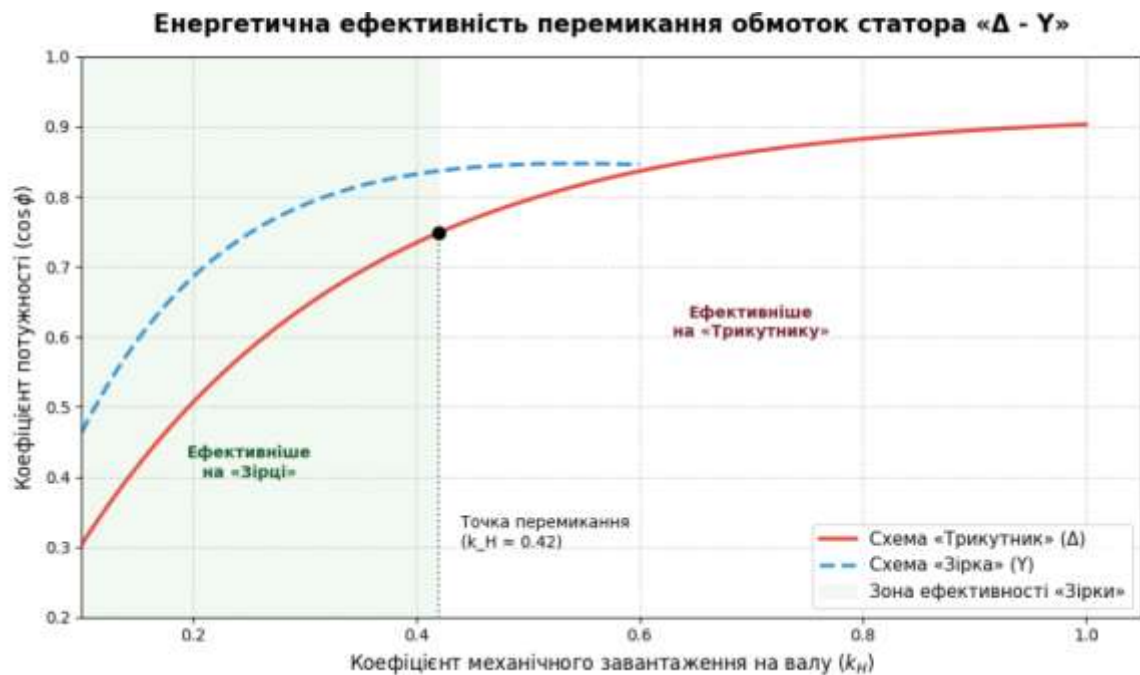
Рисунок 7.5. Залежність коефіцієнта потужності ( \cos \varphi ) асинхронного двигуна стрічкового конвеєра від коефіцієнта завантаження при різних схемах з'єднання обмоток
