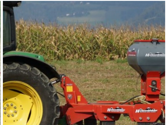
Рисунок 3.8 – Глибкорозпушувач Дельта компанії Hatztenbichler з набором робочих органів [28]
