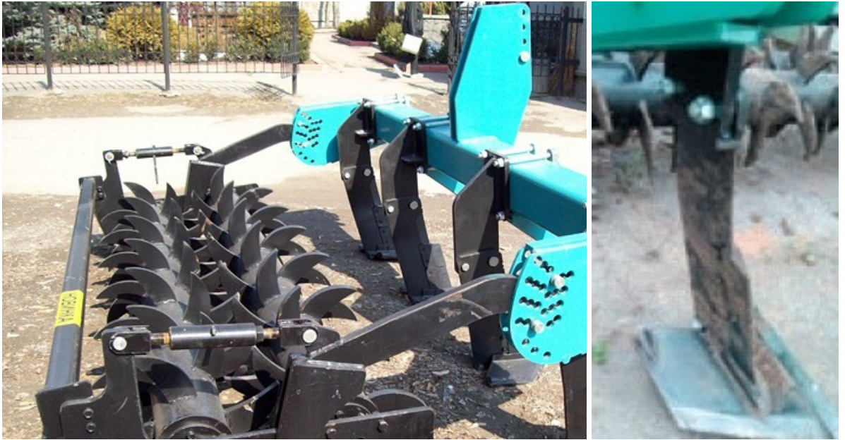
Рисунок 3.2 – Чизель-глибокорозпушувач ЧГ-40-02 виробництва підприємства «Краснянський Агромаш» [18]
