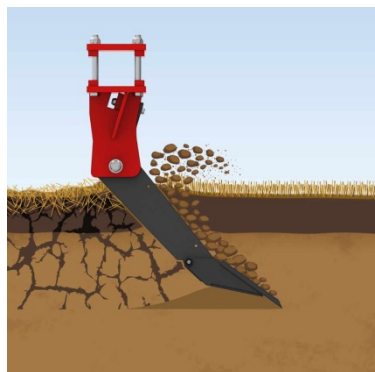
Рисунок 3.10 – Глибкорозпушувачі Helios та варіанти застосування робочих органів [30]
