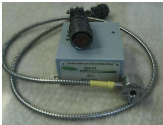
Рисунок -3.2 Індуктивний датчик віброприскорень
