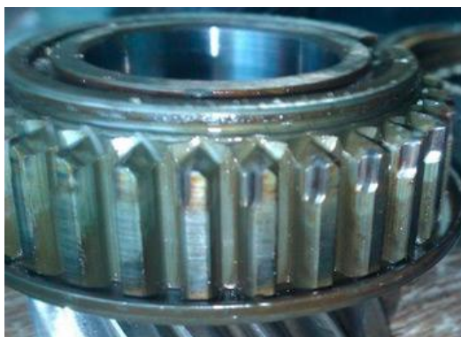
Рисунок 2.3 - Зношення зубів шестерні коробки передач
