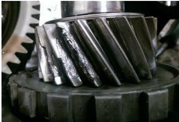
Рисунок 2.4– Викришування зубів шестерні вторинного валу
