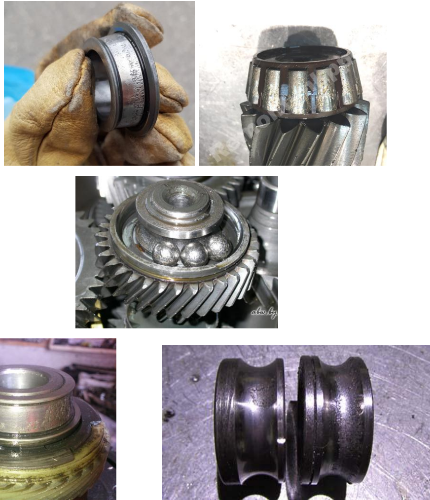
Рисунок 2.6 - Зношення підшипників коробки передач
