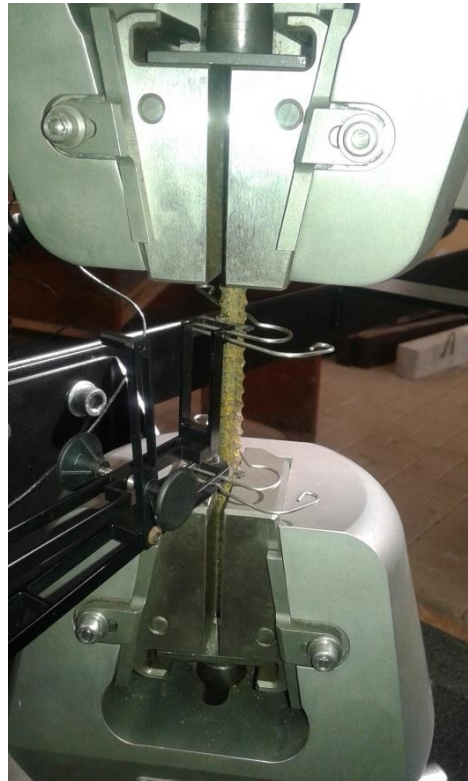
Рисунок 2. Випробування металевої арматури методом осьового розтягу
