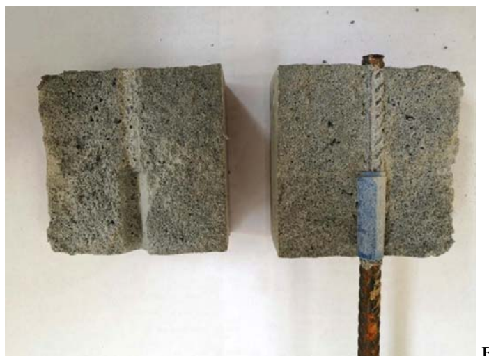
Рисунок 9. Характер порушення зчеплення арматури з пінобетоном: а) арматури АСК-1; б) арматури АБК-2; в) металевої
