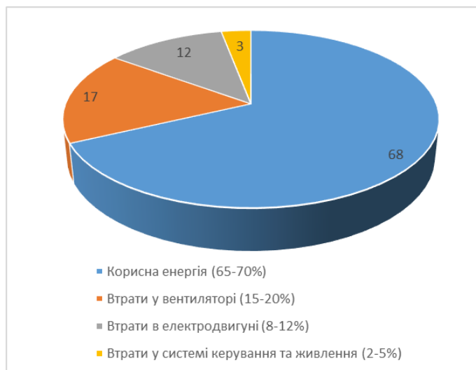
Рисунок 2.1 - Енергетичний баланс типової вентиляційної установки
