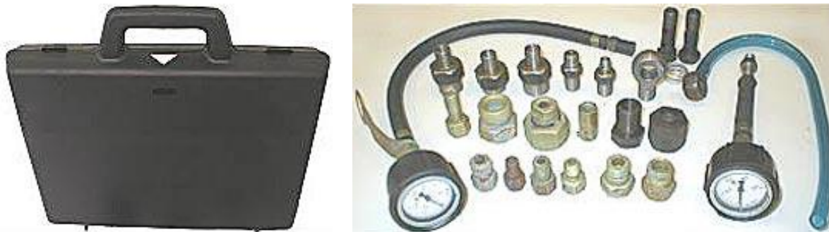
Рис. 4.3. Універсальний тестер параметрів тисків у гідросистемі, пневмосистемі і системах ДВЗ машин КИ-28156 ГосНИТИ
