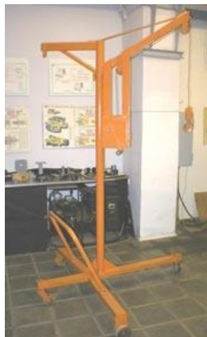
Вантажопідійомний пристрій для монтажу і демонтажу гідроагрегатів ОПТ-28138-ГОСНИТИ
