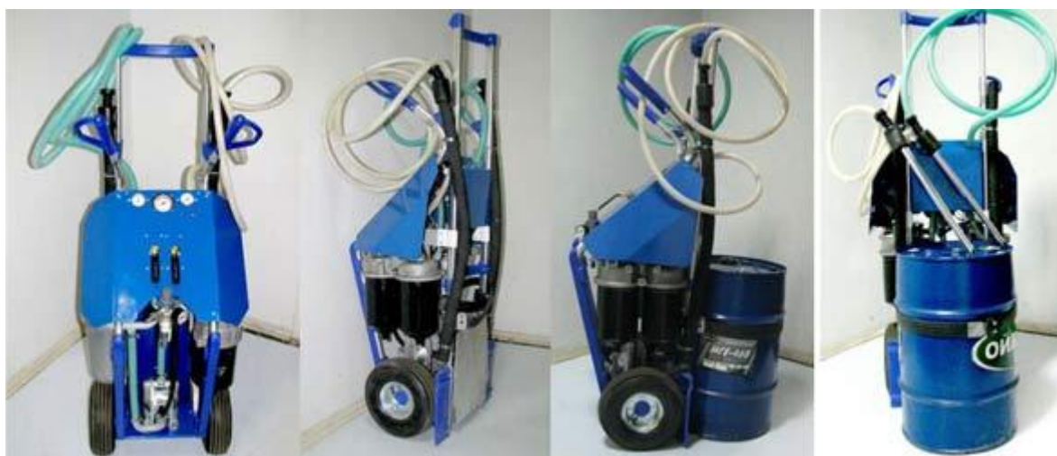
Рис. 1.3. Мобільна установка (станція) для заправлення і фільтрації гідравлічного масла КИ-28286.50 ГосНИТИ
