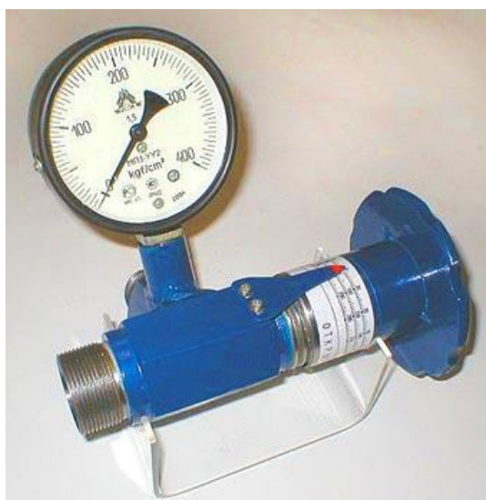
Рис. 2.2. Дросель гідравлічний (дросель-витратомір) ДР-350М (КИ-28159)
