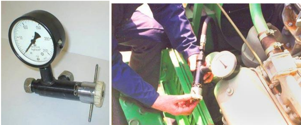
Рис. 2.1. Дросель гідравлічний (дросель-витратомір) ДР-90М (КИ-1097-1)
