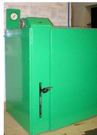
Установка (станд) для випробування гідрошлангів при ремонті і техсервісі тракторів і с/г комбайнів КИ-28160-ГОСНИТИ
