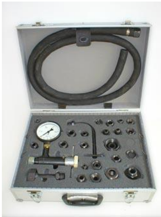
Рис. 2.3. Комплект засобів для діагностування гідроприводу КИ-5473М-ГосНИТИ на базі гідравлічного дросель-витратоміру ДР-90М (КИ-1097-1)
