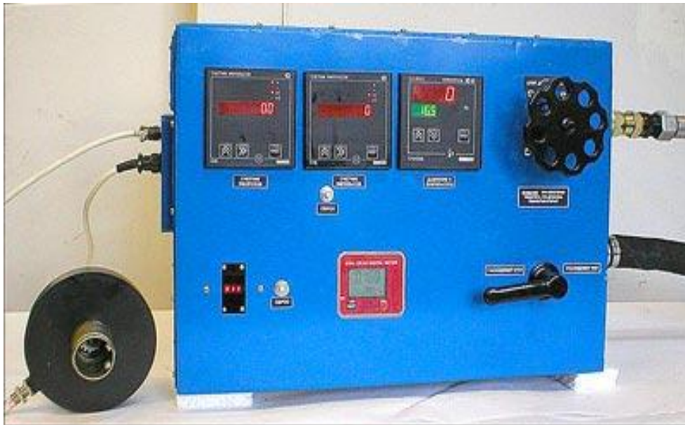
Рис. 2.4. Універсальний гідротестер для безрозбірного діагностування гідравлічної системи рульового керування колісних тракторів і сільськогосподарських машин КИ-28240-ГосНИТИ
