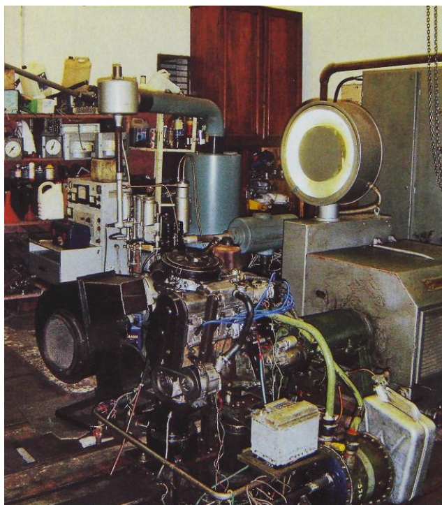
Рисунок 3.1 - Дослідно-випробувальна установка для оцінки характеристик двигуна при роботі на бензо-етанольних сумішах
