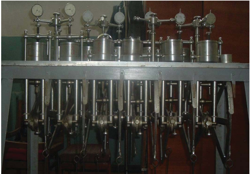
Рис. 4.27. Випробування ґрунту в приладі одноосьового стиску
