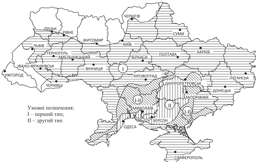
Рис. 3.3. Розміщення лесових ґрунтів за типом просадочності
