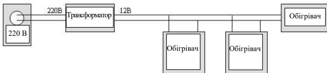
Рисунок 3.4 – Схема підключення обігрівачів
