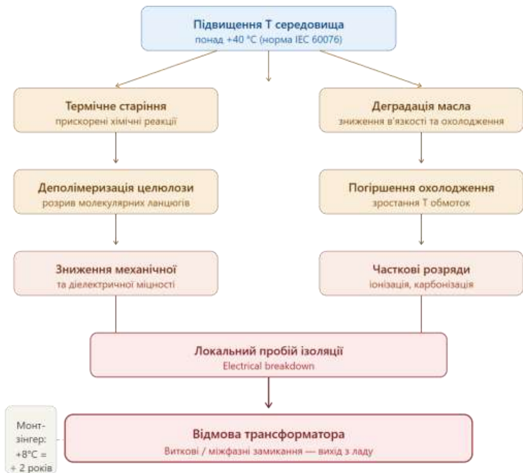
Рисунок 7.2.1 - Вплив підвищеної температури на ізоляцію
