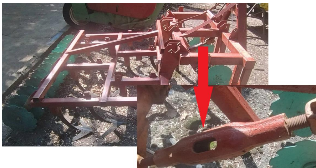
Рис. 2.2. Механізм регулювання кута атаки робочих органів ґрунторозпушувача ГРН-1,6
