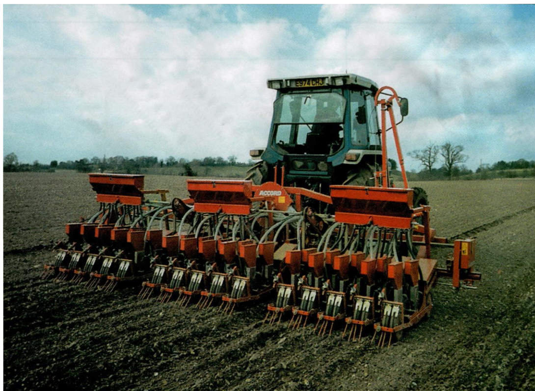
Рис 3.3 Сівалка універсальної сівби «MiniairS»
