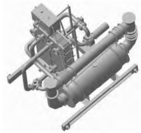
Рис. 1.3. Загальний вигляд блоку утилізації теплоти КГУ [6]
