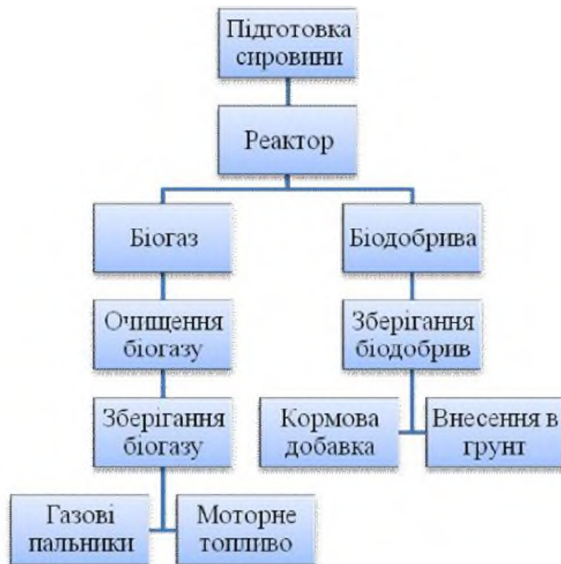
Рис.2.1 Схема технологічного ланцюга переробки біомаси в біогазових установках [16].
