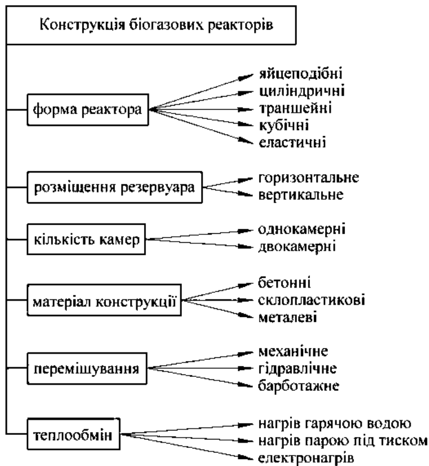
Рис.2.5. Класифікація біогазових реакторів за конструктивними ознаками
