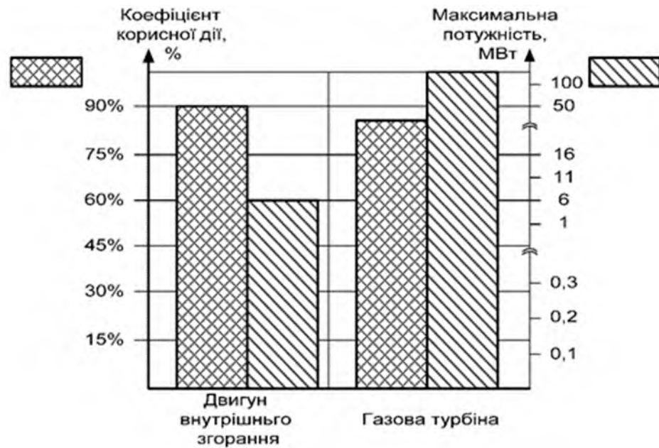
Рис. 1.10. Порівняльний графік залежності ККД та електричної потужності (МВт) ГКУ залежно від типу первинного двигуна
