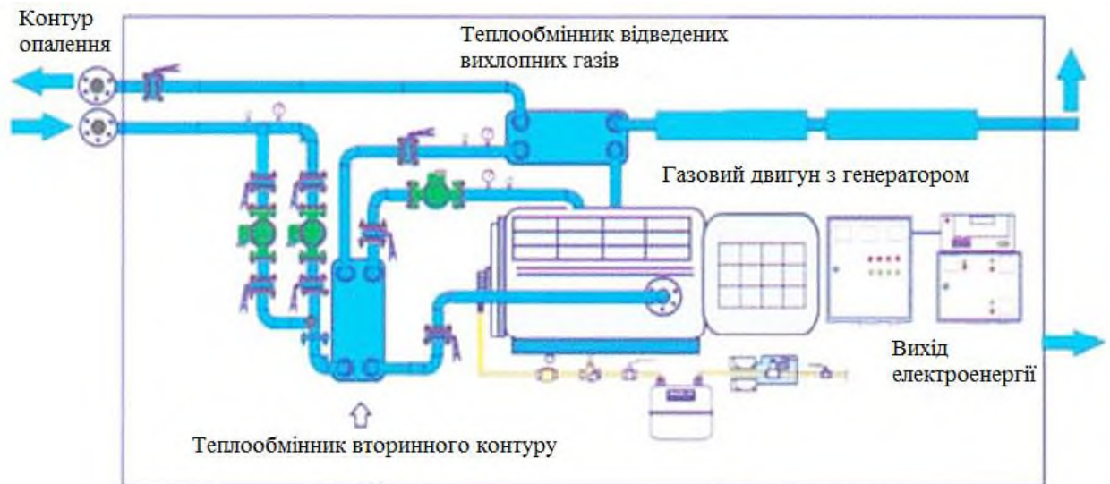
Рис. 1.5. Принципова схема газопоршневої когенераційної установки з газовим поршневим двигуном
