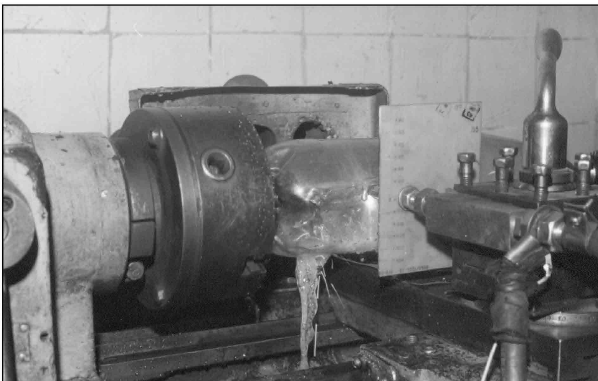
Рис. 1.9. Електроерозійна головка для РОД тіл обертання в дії на токарному верстаті
