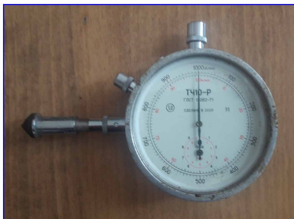
Рис. 2.6. Тахометр типу ТЧ10-Р для вимірювання швидкості обертання шпинделя на токарному верстаті
