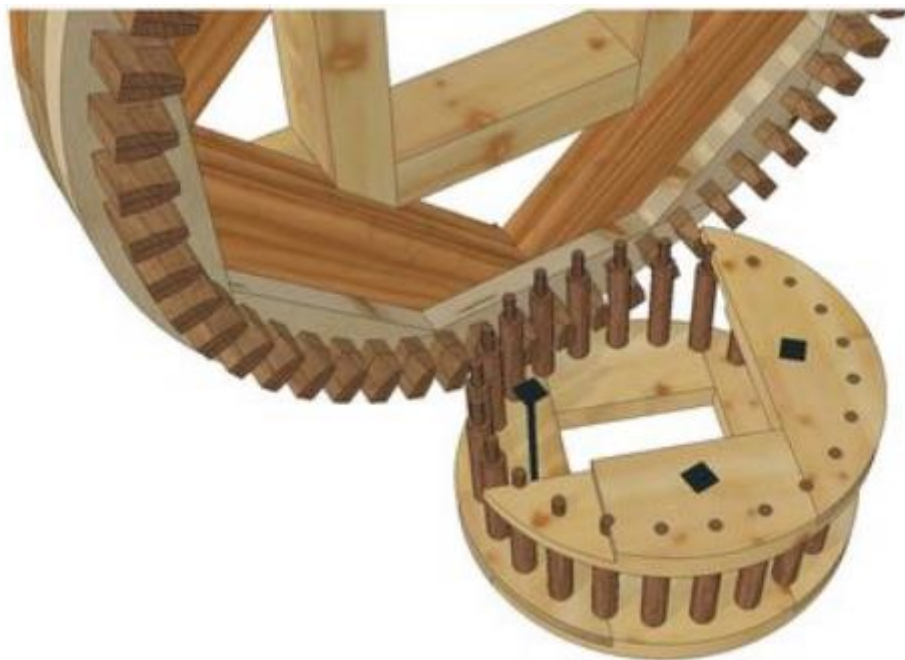
Рис. 4.2 Цівкова передача вітряного млина
