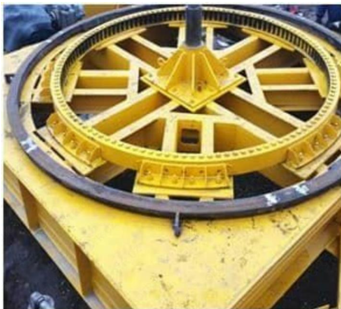
Рис. 4.3 Цівковий круг для механізму повороту крана
