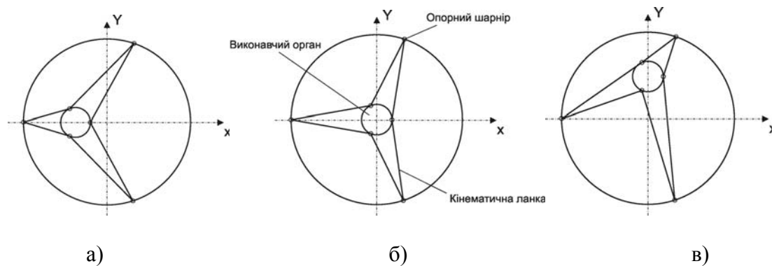
а) переміщення виконавчого органа відносно осі X ; б) виконавчий орган розташований у центрі симетрії системи; в) переміщення виконавчого органа відносно осі Y
