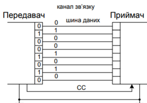
Рисунок 3.3- Схема паралельного інтерфейсу обміну для 8-бітної шини даних.
