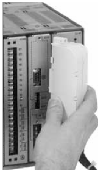
Рисунок 1.6 - Установка модуля підключення струмових ланцюгів
