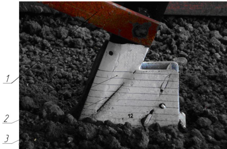
Рис. 2. 9. Вимірювання глибини вільного занурення.
