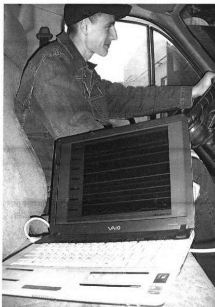
Рисунок 3.2 - Зняття даних за допомогою діагностичного комплексу «Мотор-тестер»
