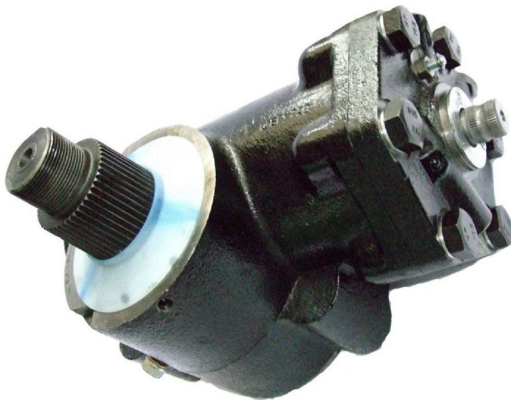
Рис. 1.1. Кульково-гвинтовий гідропідсилювач ШВГУ 700
