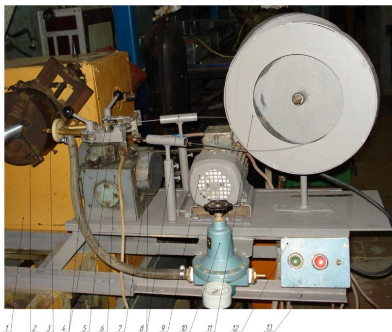
Рисунок 2.11 - Апарат електродугового напилення МІГ-2: 1 – обертач, 2 – трикулачковий патрон, 3 - розпилююче сопло; 4 –затиски; 5 – подаючі ролики; 6 - червячний двоступінчастий редуктор; 7 - корпус для змінних шестерен; 8 - діелектричні направляючі, 9 – електродвигун, редуктор тиску стислого повітря; 10 - штатив та касети з дротом; 11 – пульт управління; 12 - каретка.
