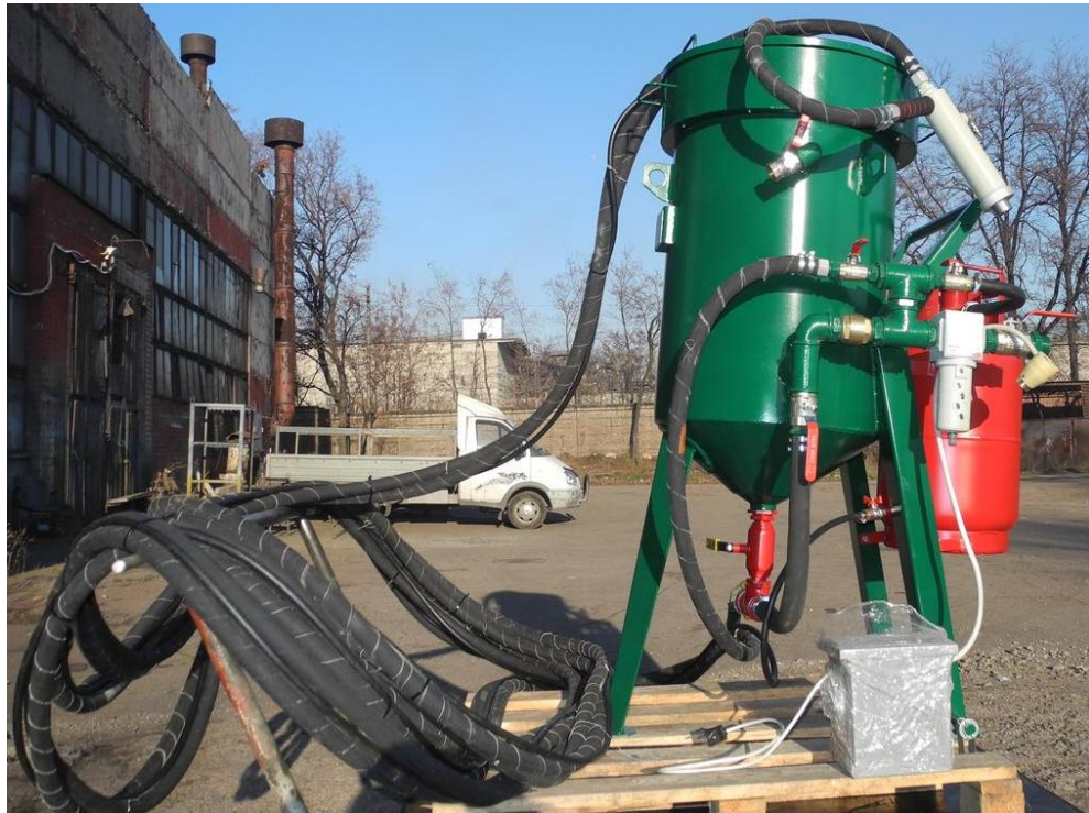
Рисунок 2.6 -Термоабразивна установка ТАУ-200
