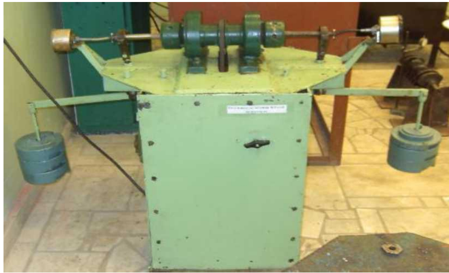
Рисунок 2.16 - Установка для втомних випробувань циліндрових зразків типу «вал» У-20
