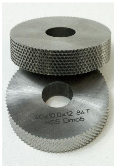
Рисунок 2.9 - Накатні ролики з різним профілем: а) прямим; б) точковим; в) сітчастим
