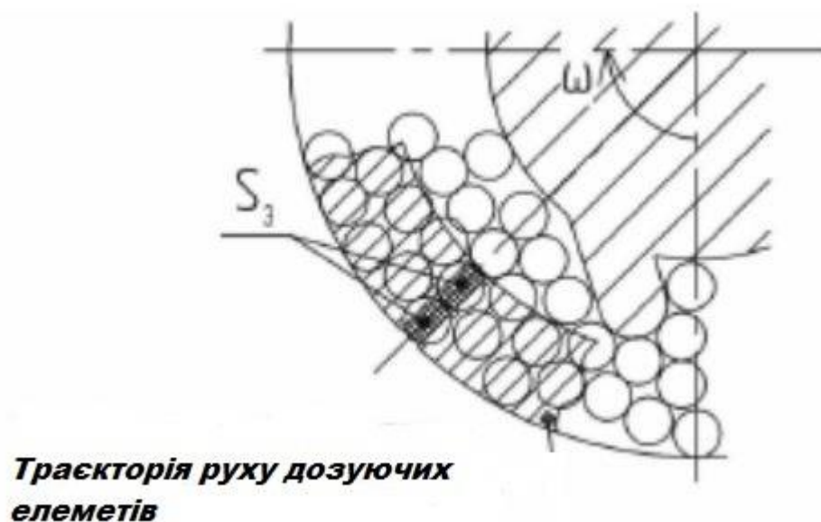
Рисунок 3.19 Схема розташування насіння у дозуючого елемента модернізованого висівного диску
