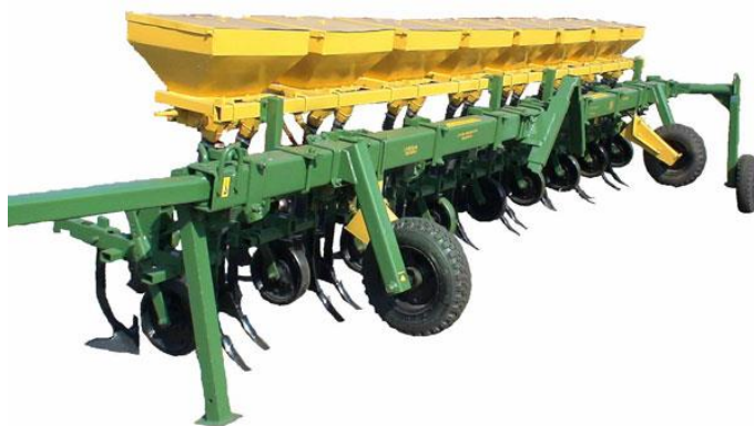
Рис. 3.11. Культиватор начіпний для вискостебельних культур КРНВ-5,6 (загальний вигляд з підживлюючим пристосуванням)
