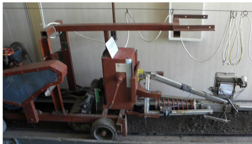
Рис. 3.17. Загальний вигляд лабораторної установки для дослідження параметрів функціонування лапи з пружною ланкою
