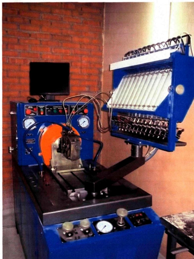
Рисунок 2.2 - Загальний вид стенду для перевірки та випробування паливної апаратури дизелів сміттєвозів
