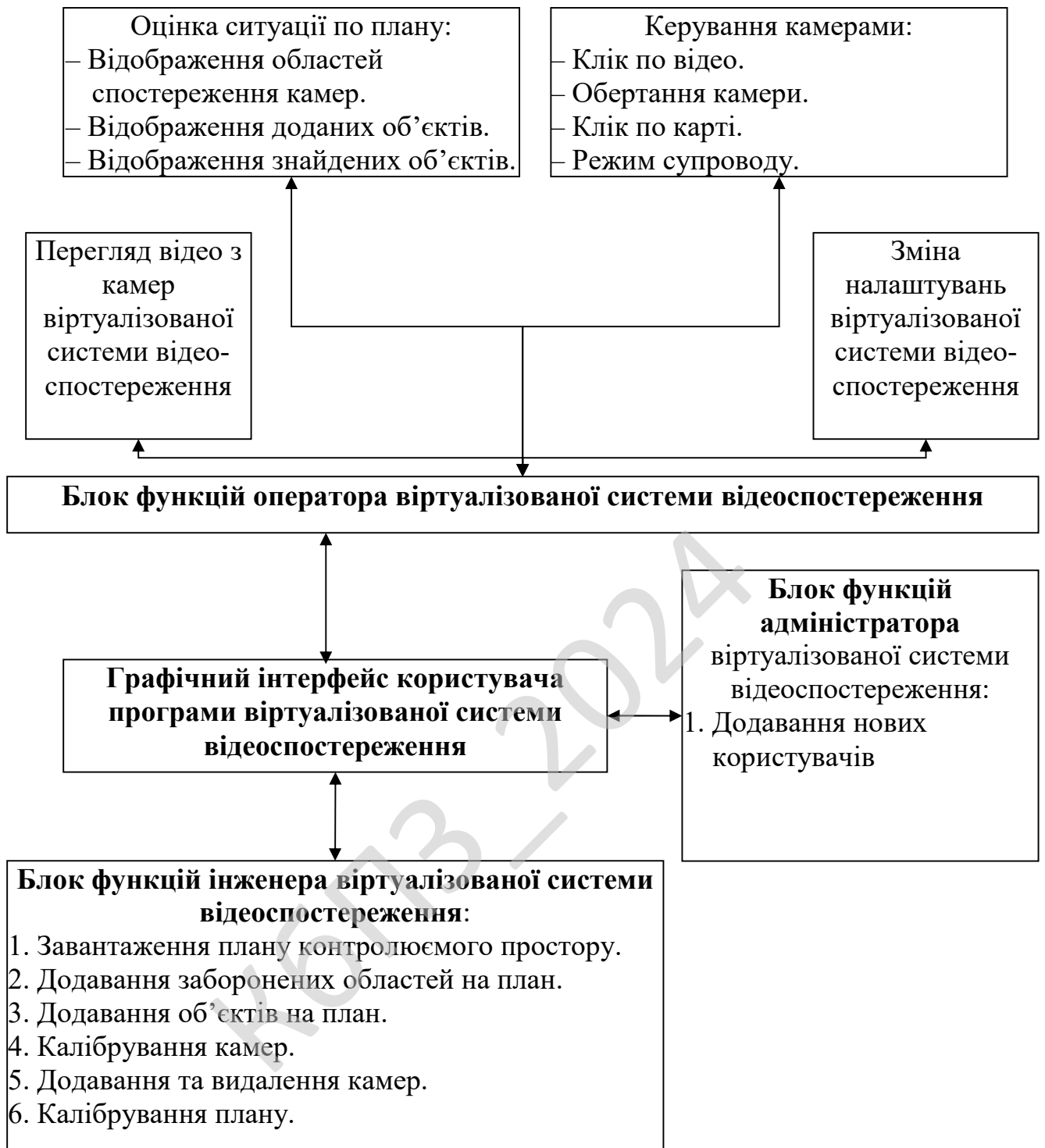
Рисунок 3.2 – Функціональна схема системи
