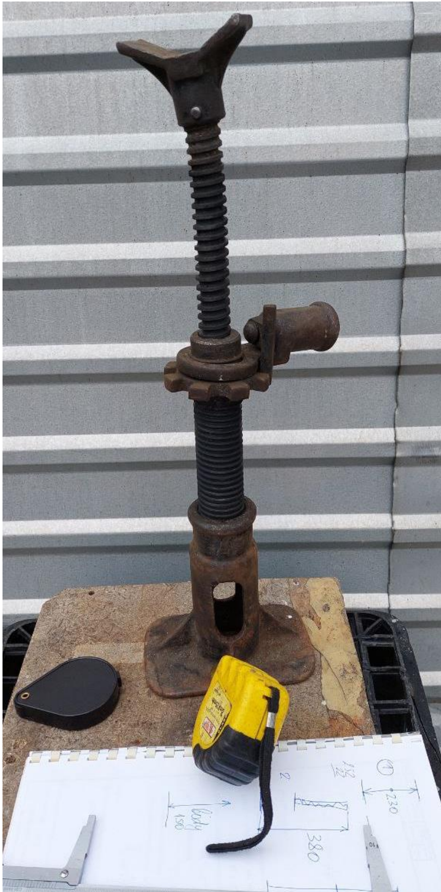
Рисунок 1.3– Максимальна висота підйому 480 мм
