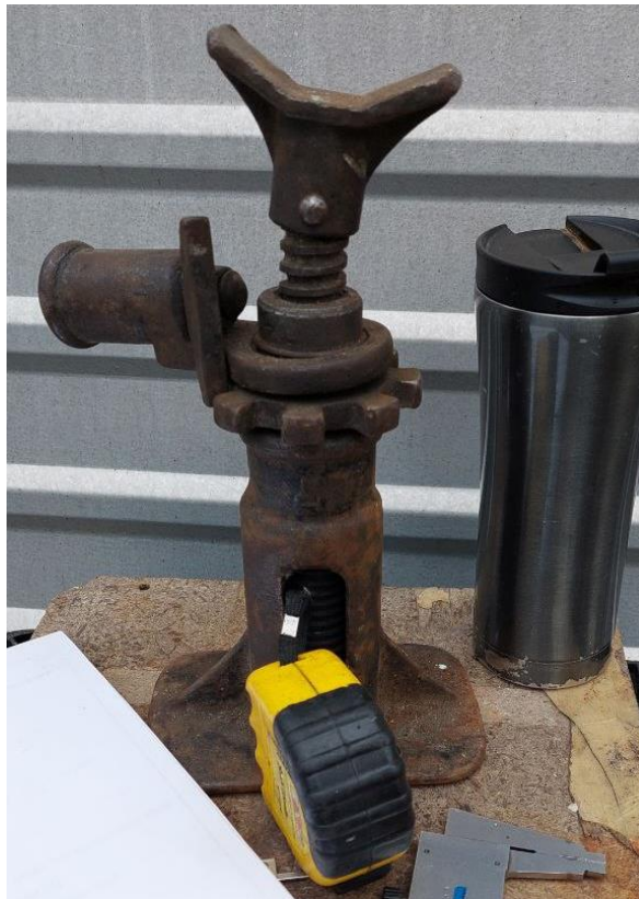
Рисунок 1.2– Домкрат у мінімальному положенні 230 мм
