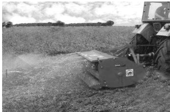
Рис. 5. Машина з горизонтальним робочим органом IMT 618.059 фірми Standart (Сербія) шириною захвату 2,8 м з поворотним щитком
