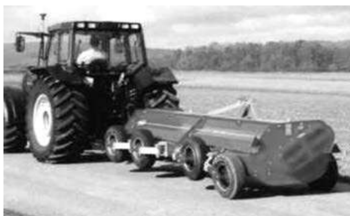
Рис. 9. Начіпна машина з горизонтальним робочим органом RM 400 фірми Kuhn (Франція) з шириною захвату 4 м (в транспортному положенні)
