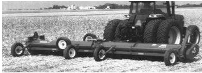
Рис. 7. Машина з горизонтальним робочим органом RC 25 фірми Phino (США) шириною захвату 7,62 м
