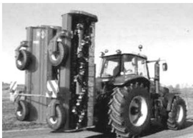
Рис. 8. Машина з горизонтальним робочим органом RM 610 фірми Kuhn (Франція) з шириною захвату 6,1 м (в транспортному положенні)
