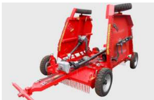
Рис. 37. Подрібнювач рослинних решток ПРР-4,5:
