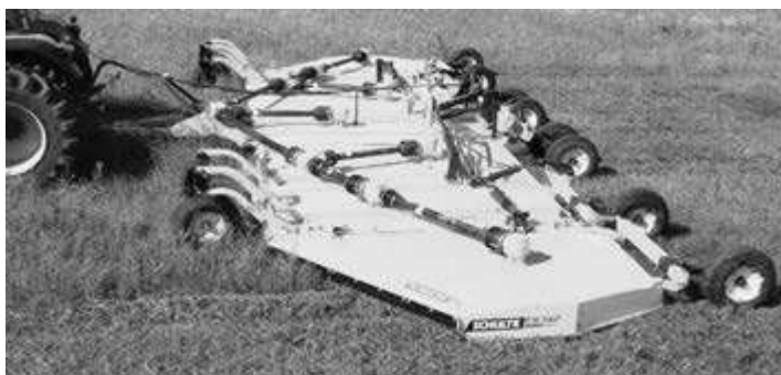
Рис. 13. Машина з вертикальними робочими органами FX 742 фірми Schulte (Канада) шириною захвату 12,8 м
