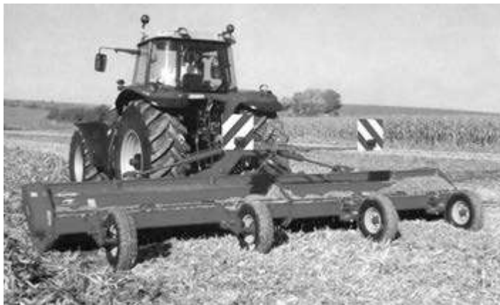
Рис. 1. Компанія Kuhn (Франція) випустила машину RM 610 з горизонтальним робочим органом, яка має ширину захвату 6,1 метра.
