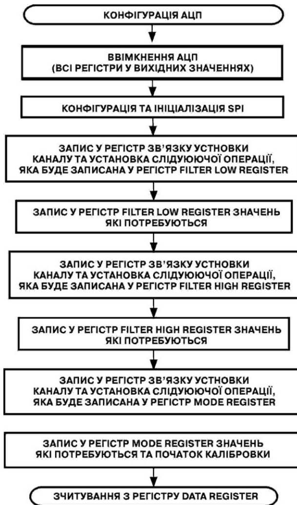
Рисунок 4.13 – Алгоритм конфігурування АЦП
