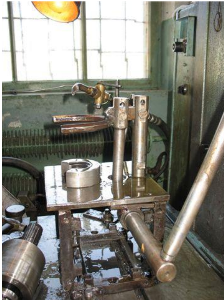
Рис.3.5. Кондуктор для встановлення корпусів при обробці на вертикально-свердлильному верстаті
