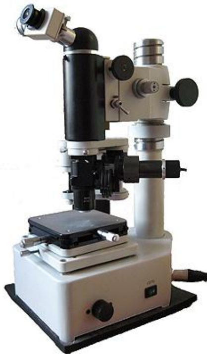
Рис.3.13. Прилад ПМТ-3 для вимірювання твердості
