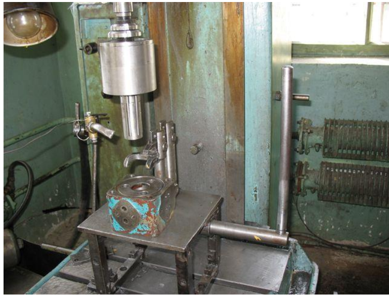
Рис.3.4. Робоча зона пристрою для обробки переривчастих отворів чавунних корпусів поверхневим пластичним деформуванням
