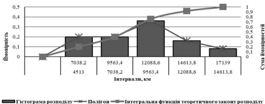
Рисунок 2 – Гістограма розподілу, полігон розподілу, графік накопиченої дослідної ймовірності повітряного фільтра PE07-13-3A0A двигуна SKYACTIV-G 2.0 автомобіля Mazda
