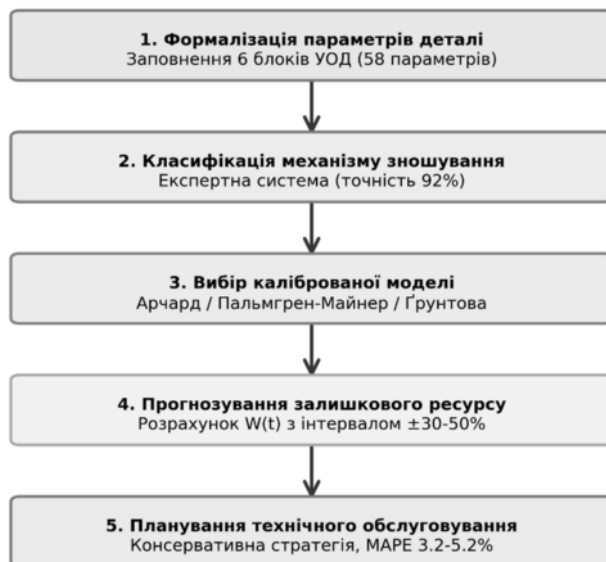
Рисунок 6 – Блок-схема реалізації методу УОД, п'ять етапів: від формалізації параметрів до планування технічного обслуговування
