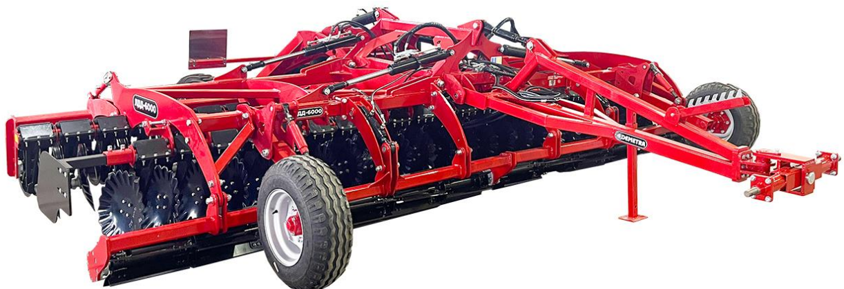
Рис. 2.1. Загальний вигляд луцильника ЛДГ-6000 (виробництво Dementia)
