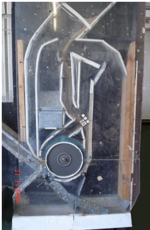
Рис. 3.2. Експериментальна установка для дослідження каналу з вертикальним розділювачем зерна
