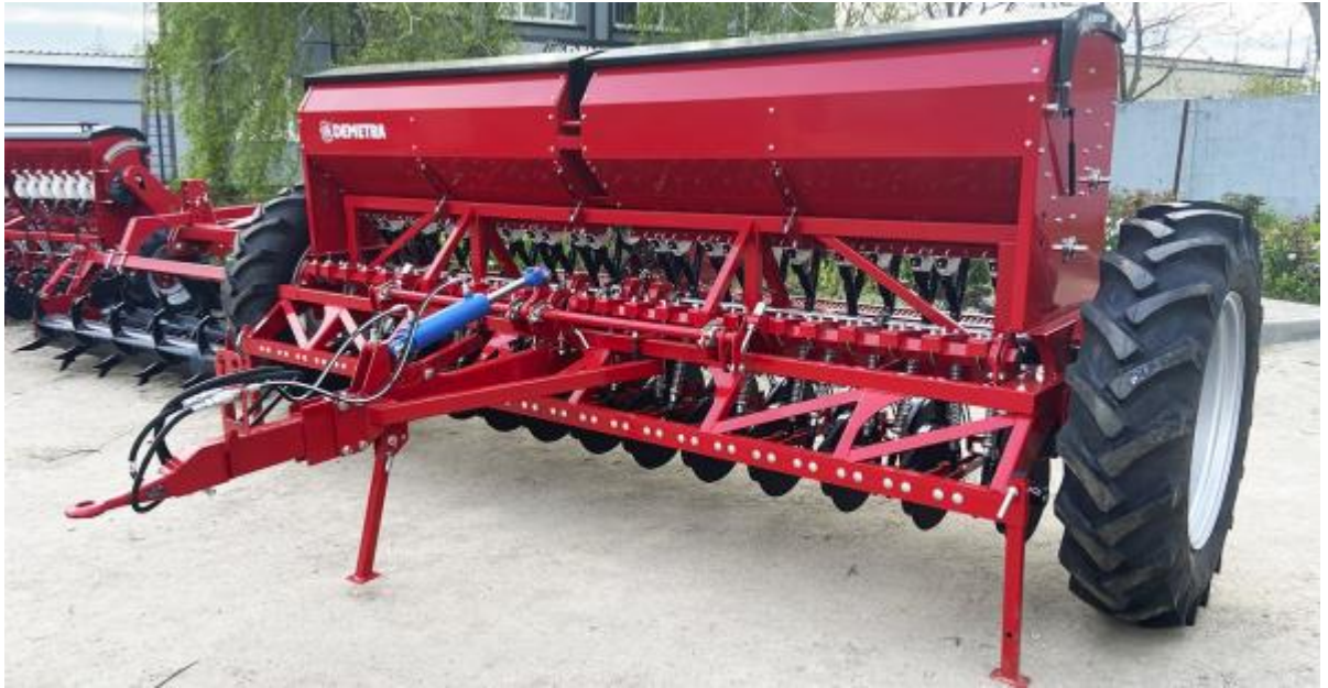
Рис. 2.2. Сівалка СЗ-3,6 (виробник Dementia)
